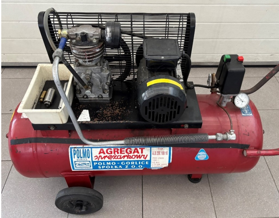
Rys. 5. Agregat sprężarkowy jako stanowisko pomiarowe
