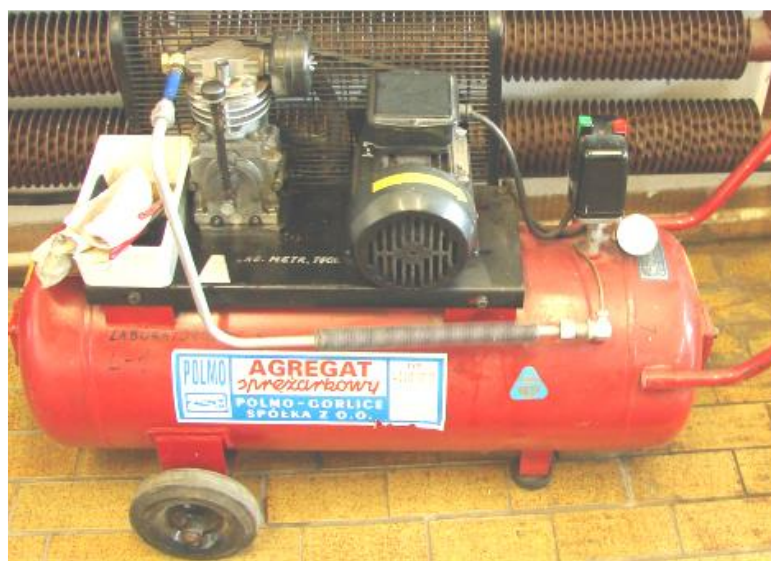
Rys. 5. Agregat sprężarkowy jako stanowisko pomiarowe
